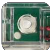
Электронная пломба для оповещения от вскрытия клеммной крышки
