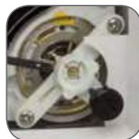
Настройка нулевого положения стрелки
