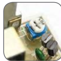
Возможность корректировки выходного напряжения
