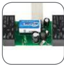
Два встроенных реле на токи до 16 А
