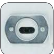
Оптопорт для снятия данных и программирования счётчика
