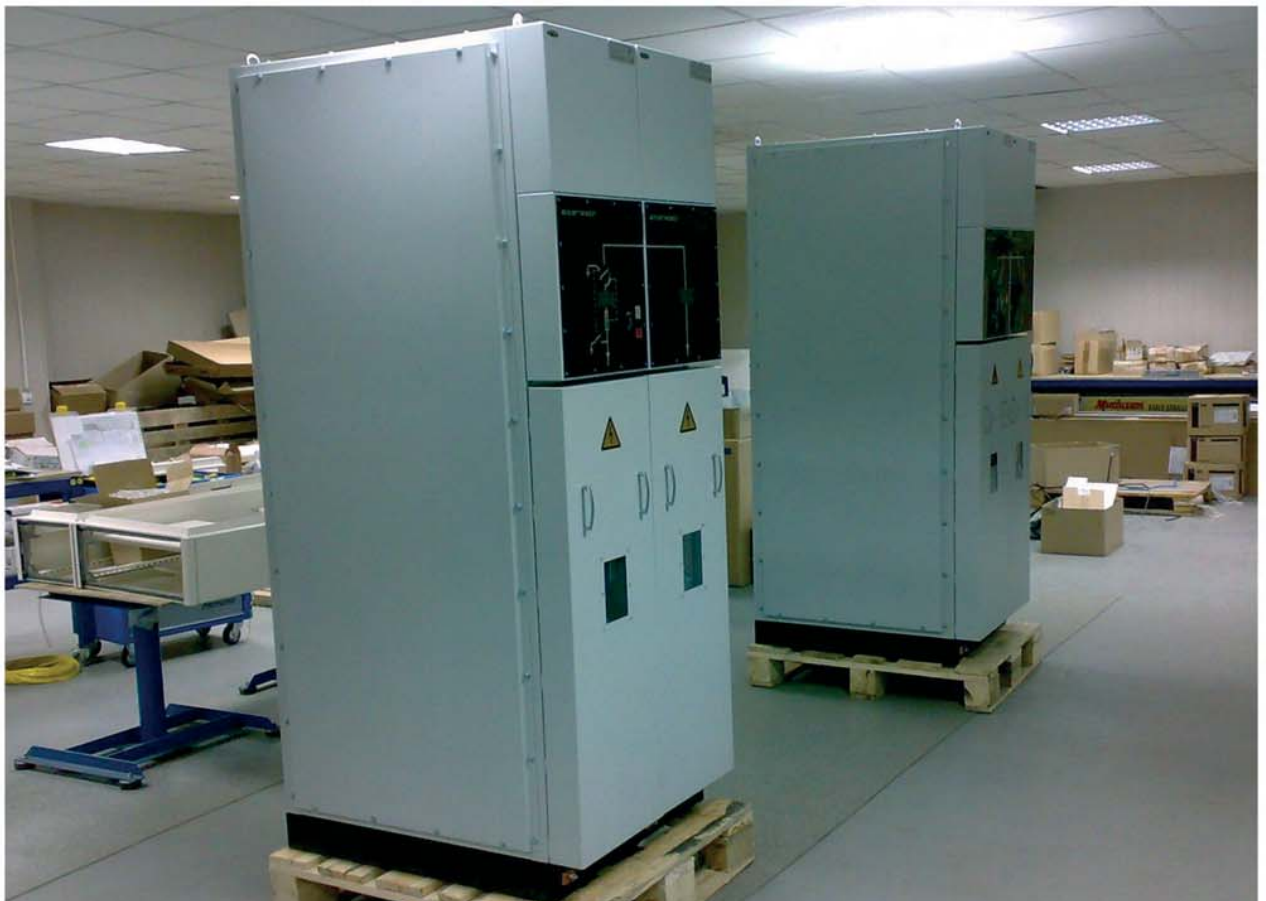
Рис. 2.1.6 Пример типового решения шкафов ввода из ячеек КСО-207-Оскол с выключателем нагрузки и предохранителями
