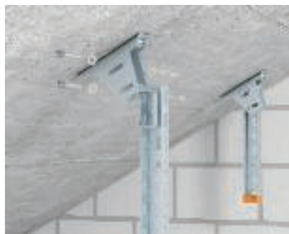
Траверса регулируемая Крепление регулируемой траверсы KU 5 V на наклонном бетонном потолке с помощью анкерных болтов FAZ II и распорки DSK 47.
