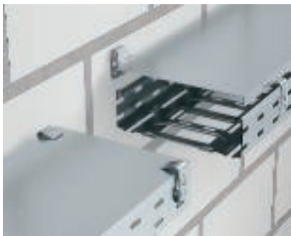
Монтаж крышки без применения болтов Безболтовой монтаж неперфорированной крышки DRLU на кабельном лотке с помощью фиксатора DKU. Фиксатор устанавливается в верхнее отверстие боковой стенки.
