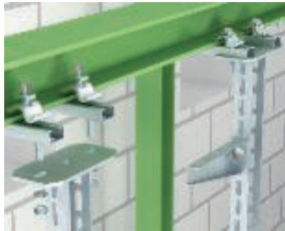
Фиксация С-образного профиля при поперечном направлении прокладки трассы Монтаж U-образной подвесной стойки на стальной балке с С-образным профилем CPS и фиксатором ТКН-L-25 при направлении прокладки трассы поперек стальной балки.
