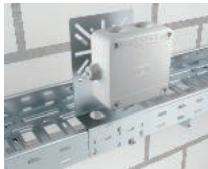
Монтажная пластина с системой быстрого крепления Крепление монтажной пластины MP на кабельном лотке. Монтажную пластину можно зафиксировать на боковой стенке кабельного лотка с помощью комплекта для быстрого соединения, а затем прочно прикрепить болтами FRS B с полукруглой плоской головкой.
