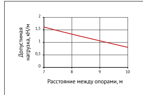
Диаграмма нагрузок на кабельный лоток
