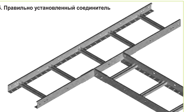
Угловой соединитель универсальный LKUC3 подходит для кабельростов Н45.
