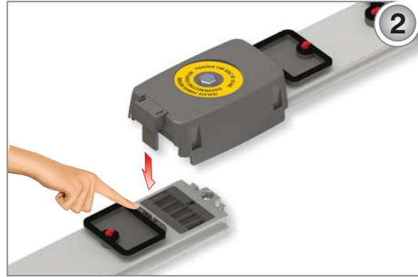
2- Выровняйте два шинпровода так, чтобы выравнивающая шпилька стыковочного модуля попала в гнездо другого разъема, как указано на рисунке.
