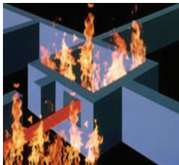
Любые технические отверстия в помещении (двери, вентиляция, кабели) являются потенциальной угрозой.
