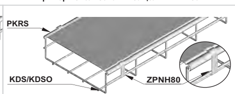
Пример использования защелки ZPNH80
