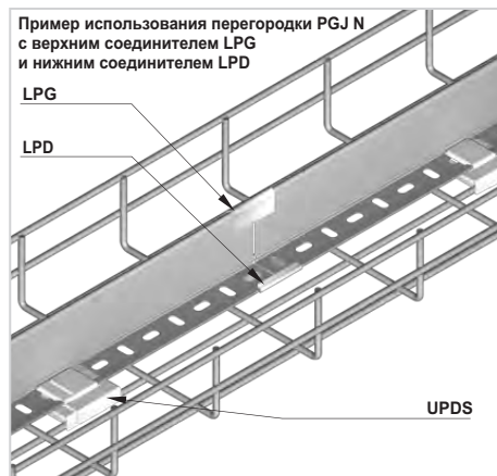
Пример использования держателя UPDS. Поэтапный монтаж:
