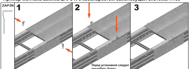
Пример монтажа зажима ZAP3 N с кабельростом самонесущей системы H150
